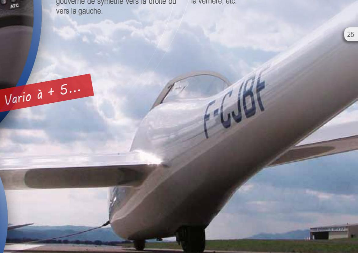
Les planeurs modernes sont les engins les plus aérodynamiques qui soient. Biplaces ou monoplaces, ils sont profilés, en matière plastique (fibre de verre) ou en carbone. Le très haut degré de finition des surfaces, dont dépendent leurs performances, fait l'objet d'un entretien méticuleux.
